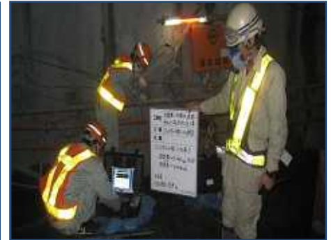
状況写真NO.2 ロックボルト4,000mm測定
